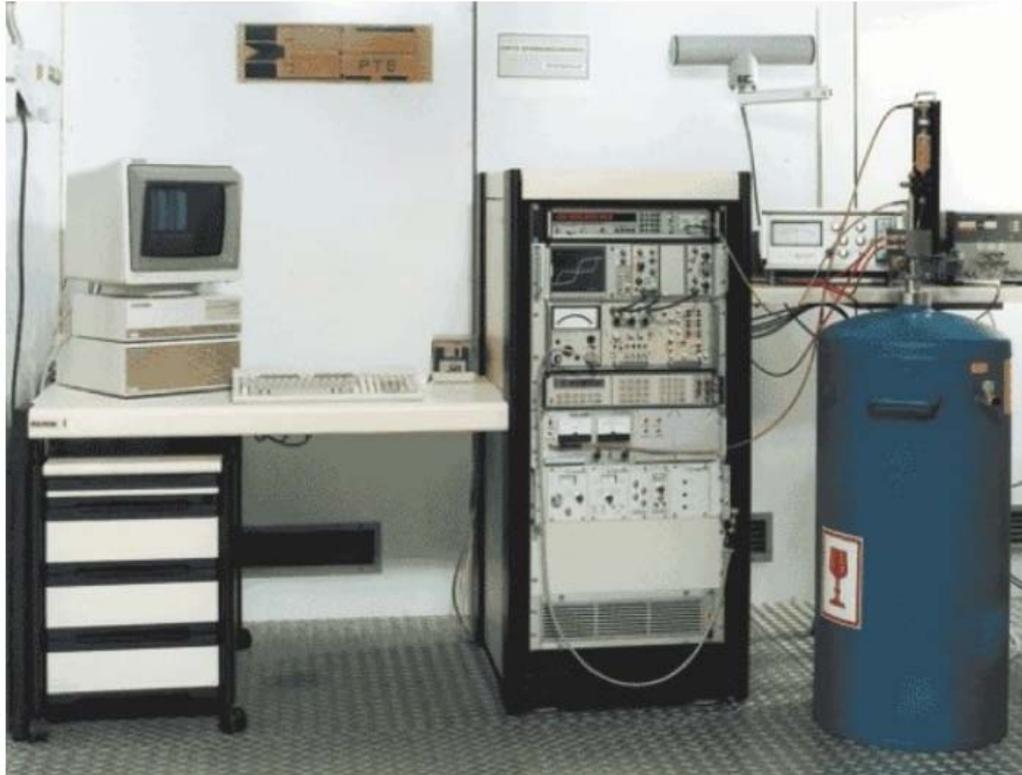
**Spannungsnormal 3:** Kryo-Spannungsnormal der PTB. Rechts: 10-V-Chip in Behälter für flüssiges Helium bei  $T = 4,2$  K; Mitte: Apparaturen mit Mikrowellenversorgung und peripheren Geräten; Rechts oben: Antenne zum Empfang der Normalfrequenz des von der Atomuhr der PTB gesteuerten Langwellensenders DCF 77.
