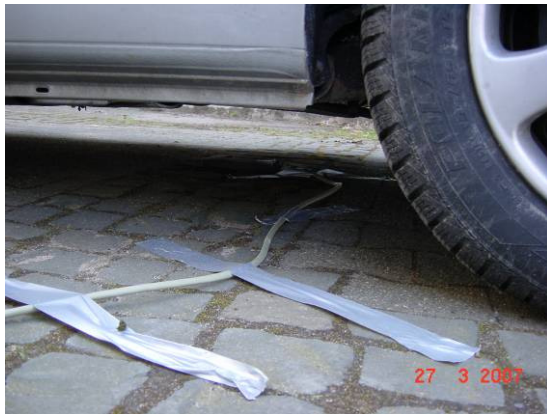
Bild 6-6: Detektorposition und Fahrzeug bei der Gradiometermessung
