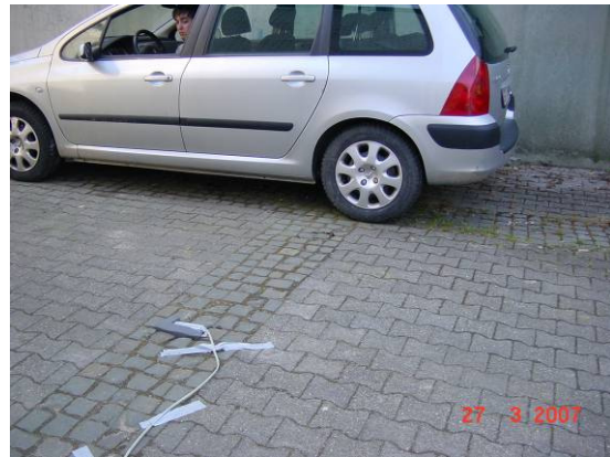
Bild 6-6: Detektorposition und Fahrzeug bei der Gradiometermessung
