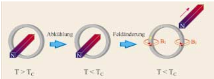
Abb. 2: Supraleiter reagieren auf Änderungen des Magnetfeldes mit entsprechenden Abschirmströmen.
