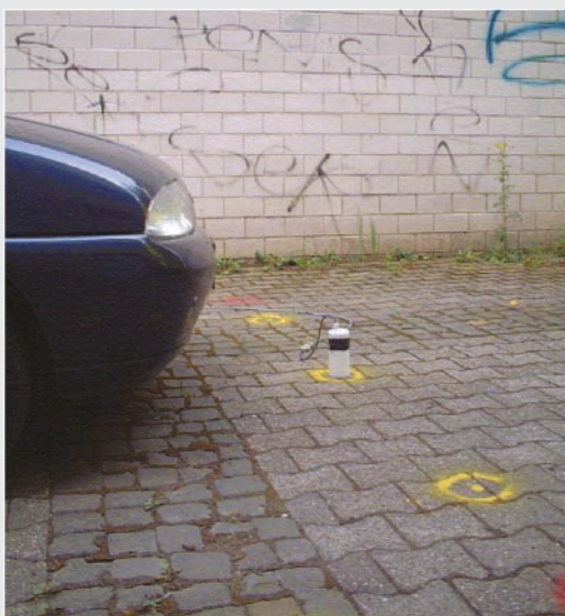
Abb. 5: Sensorposition in Bezug auf das parkende Fahrzeug (linkes Bild). Der Sensor befindet sich in Position 16 des Messfeldes (siehe Abb. 3). Die Magnetfeldprofile (rechtes Bild) zeigen deutlich die Verweildauer des Fahrzeuges an. Zur besseren Unterscheidung wurden die Profile horizontal gegeneinander verschoben.
