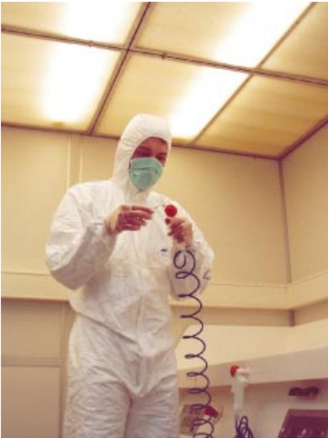
**Abb. 6: Abblasen von Lösungsmitteln von einer Probenoberfläche nach der Endreinigung. Zum Betreten des Reinraumes muss geeignete Schutzkleidung, die nahezu die gesamte Körperoberfläche bedeckt, angelegt werden.**
