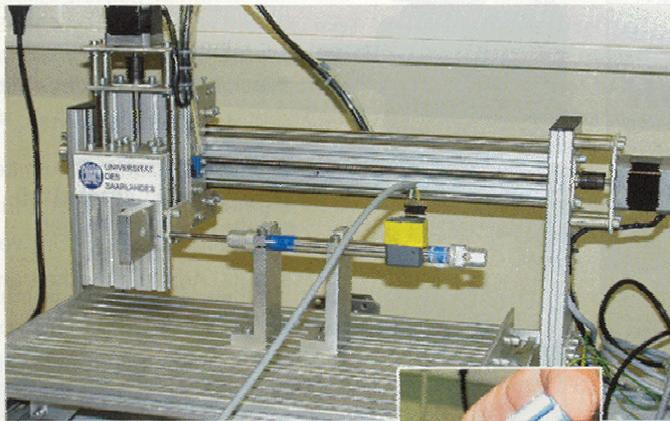
**K**arl-Wilhelm Zöllner, Geschäftsführer der Secatec Electronic GmbH aus Katzwinkel war auf der Suche. Nach einem Sensor, der die Kolbenpositionen eines Zylinders selbst bei variierenden Bewegungen auf den Millimeter genau bestimmt – also nicht nur dessen Ausgangs- oder Endposition. Der Vorgang sollte zudem berührungslose Messungen ohne jeglichen Eingriff in den Druckbereich oder den Kolben ablaufen. Doch derartige Komponenten bot der Markt nicht.
