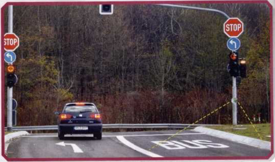
Besser als Infrarot und Induktionsschleifen: Mit dem Magnetfeldsensor sind Ampeln zuverlässig zu steuern.
