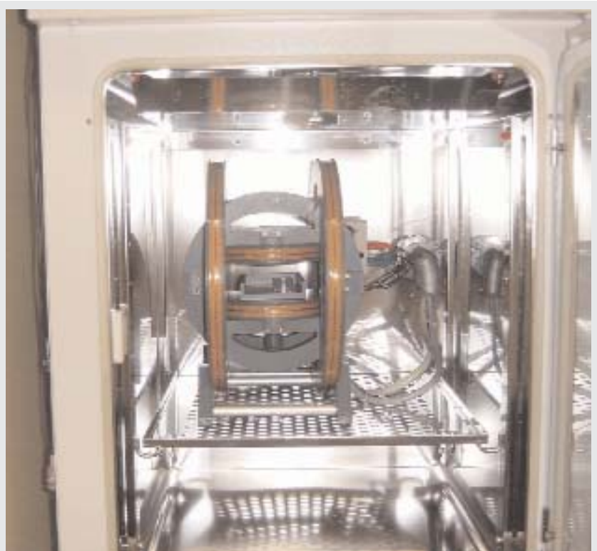
Abb. 2: Dreiaxiales Helmholtzspulenpaar, integriert in einen Brutschrank. Jede Raumrichtung ist unabhängig regelbar. Somit können definierte, homogene Magnetfelder am Probenort in der Mitte der Spulen generiert werden.
