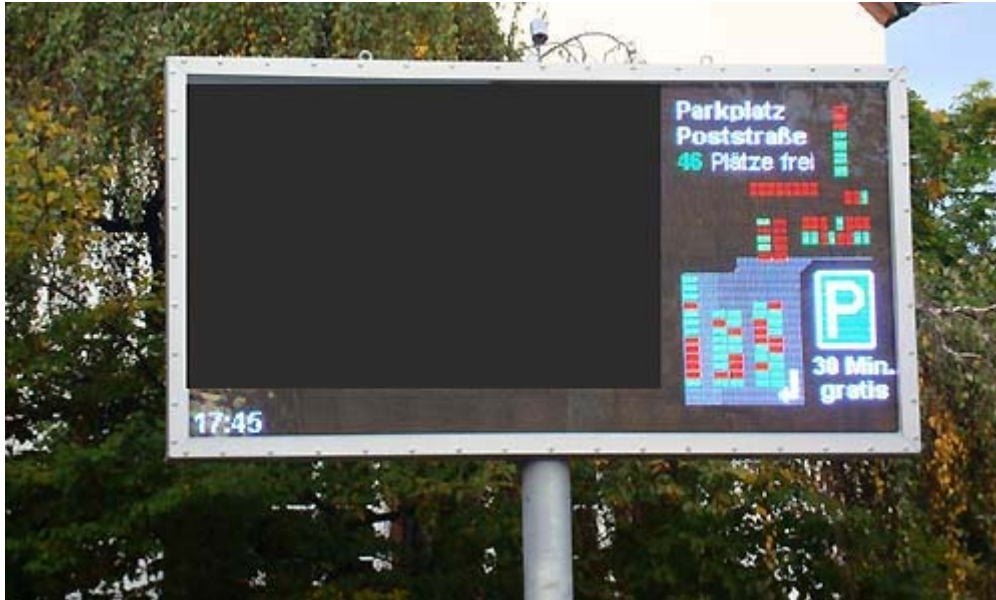
Magnetfeldsensoren erfassen parkende Autos. Auf einer Anzeigentafel kann der Autofahrer Parklücken erkennen. Foto: Universität des Saarlandes
