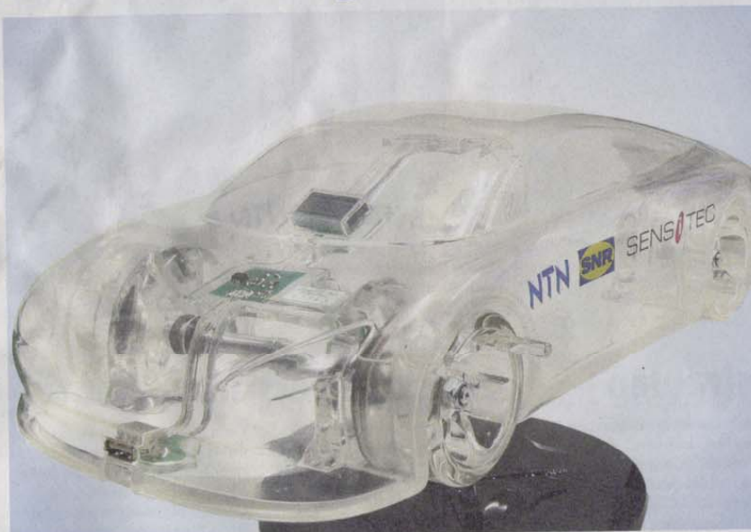
Mit magnetischen Sensoren wird die Fahrstrecke dieses Modellautos gespeichert, sodass es seinen Weg von selbst erneut fährt.
