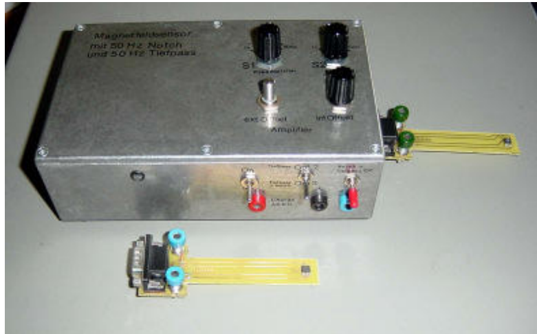
Abb. 2.1: Experimentierbox mit auswechselbaren Magnetfeldsensoren
