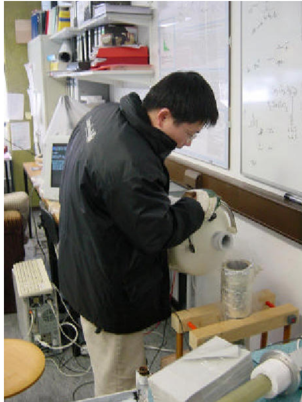
Abb. 3.2: Einfüllen des flüssigen Stickstoffs
