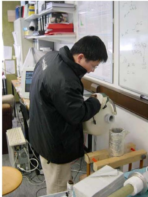
Abb 2.3: Vorsicht beim Einfüllen von flüssigem Stickstoff in den Kryostaten
